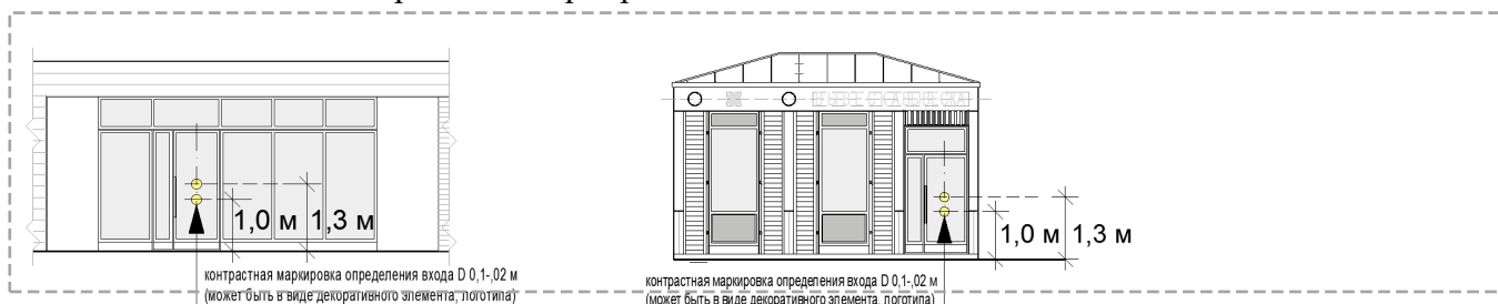
Рис. «Внешний вид контрастной маркировки входа»
