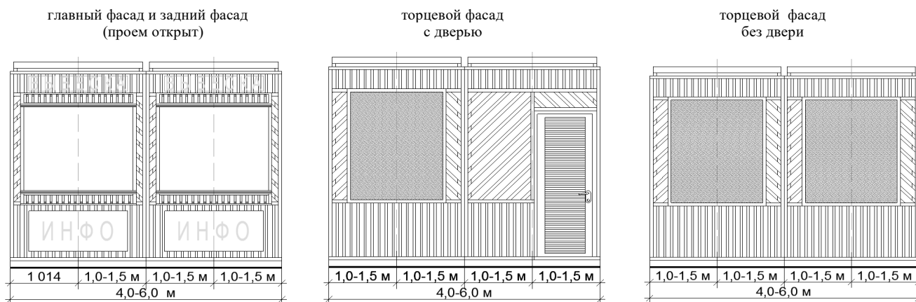
Рис. «Основные параметры места размещения нестационарного торгового объекта для палаток» схемы места размещения нестационарного торгового объекта при островном размещении модуля палатки:
