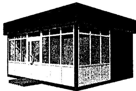
**Описание:** каркас – металлический, стены, кровля - промышленные сэндвич панели, сайдинг; витрины, двери-металлопластиковые однокамерные стеклопакеты. Фасадное и боковое остекление предусматривается из алюминиевых конструкций со стеклопакетами из витринного стекла (простого или тонированного) с защитным антивандальным покрытием (пленкой).
