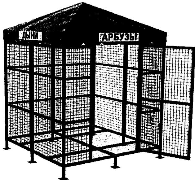
**Описание:** конструкция для временного размещения товарного запаса нестационарного торгового объекта - сборно-разборная металлическая, каркас конструкции-сварные элементы. Сварная сетка из проволоки, вся металлоконструкция загрунтована и окрашена эмалью зеленого цвета. Кровля выполнена (сварена) из тентовой баннерной ткани. Покрытие внутри конструкции выполнено из специальных деревянных поддонов высотой не менее 20см.
